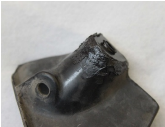
Oben: ausgebrochene Anschraubfläche und Reparatur-"Blech" Ansatz Unten: neue aufgebaute Anschraubfläche
