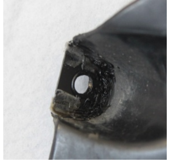
Oben: ausgebrochene Anschraubfläche und Reparatur-"Blech" Ansatz Unten: neue aufgebaute Anschraubfläche
