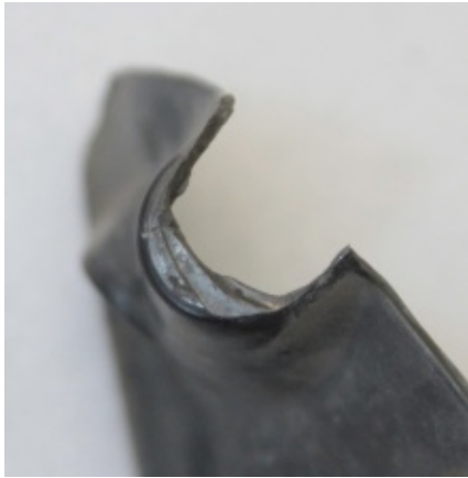
Oben: ausgebrochene Anschraubfläche und Reparatur-"Blech" Ansatz Unten: neue aufgebaute Anschraubfläche
