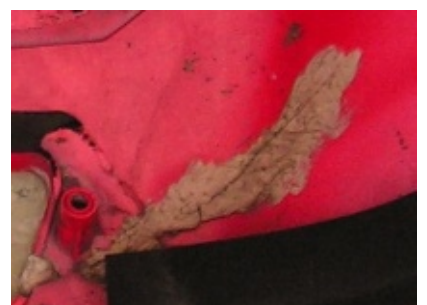
Riss vorne rechte Seite bis zur Standlichtleuchte.
