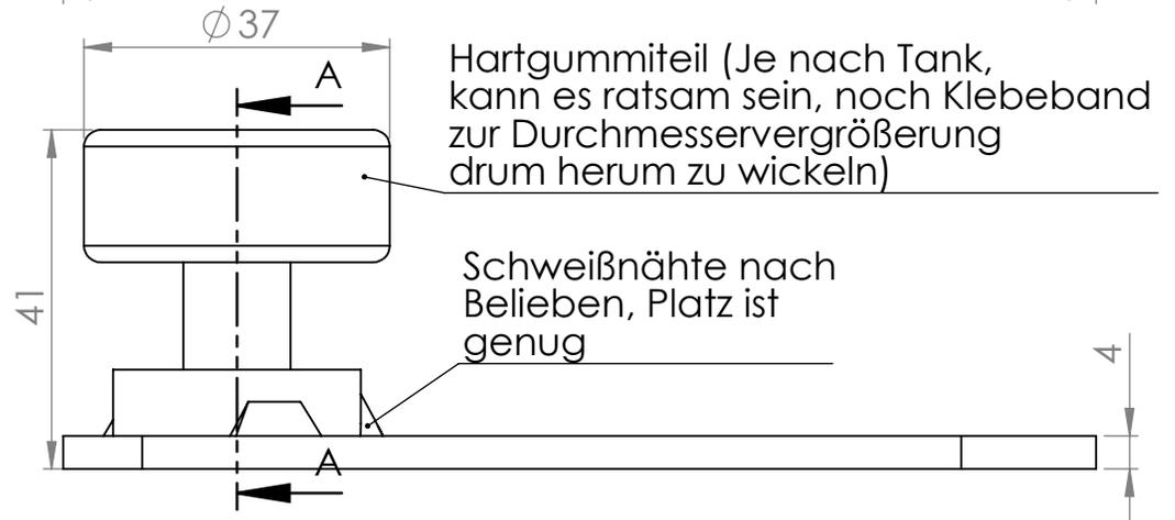
Das ganze ist die Abbildung des Originalhalters, Wichtig ist die Position des Gummiteils zu den 11mm Bohrungen und das zwischen Gummiteil und der Grundplatte die 13mm Luft sind und das 10mm tiefe 22,5mm Loch auf der Rückseite (das geht über die original Tankaufnahme) Der Rest kann beliebig gestaltet werden
