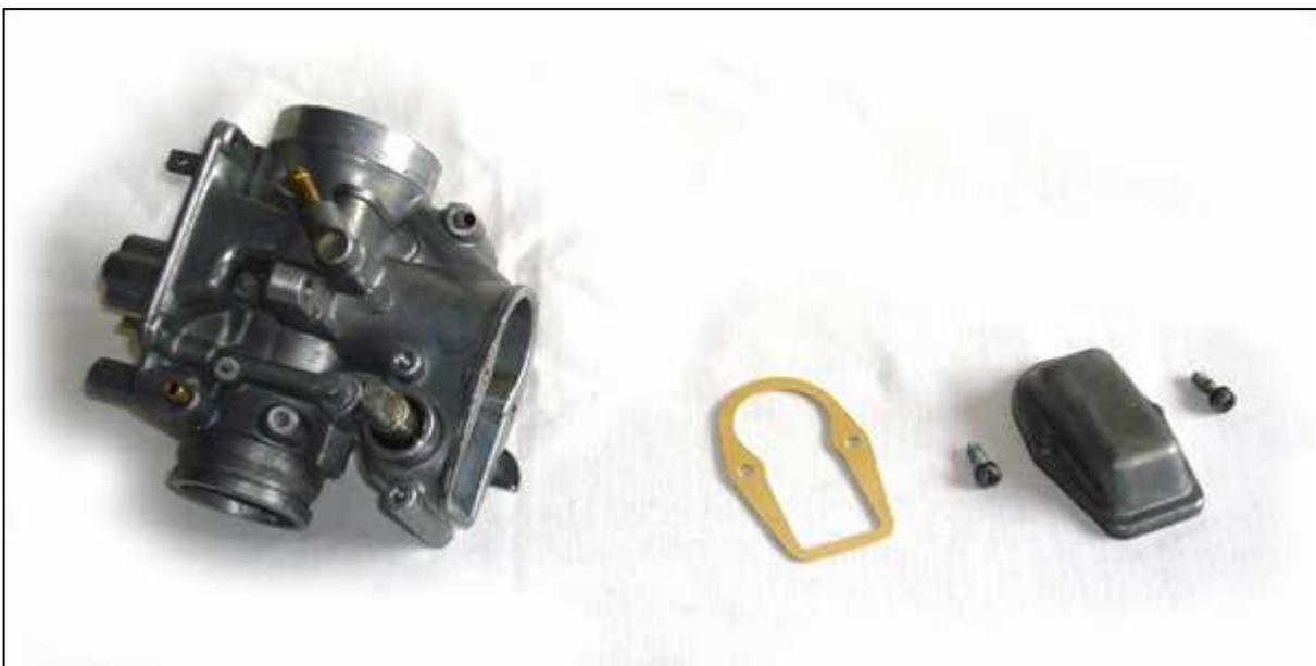
18. Kolbenschieber demontieren
