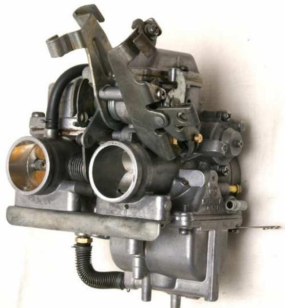
1. Unterdruckschläuche für Sekundärkolben demontieren
