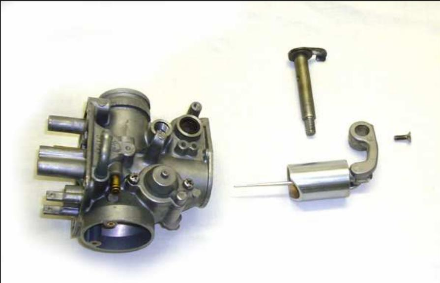
19. Kolbenschieber demontieren
