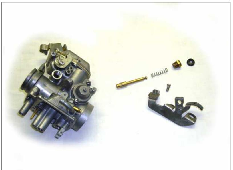
16. Kolbenschieber-Betätigung zerlegen
